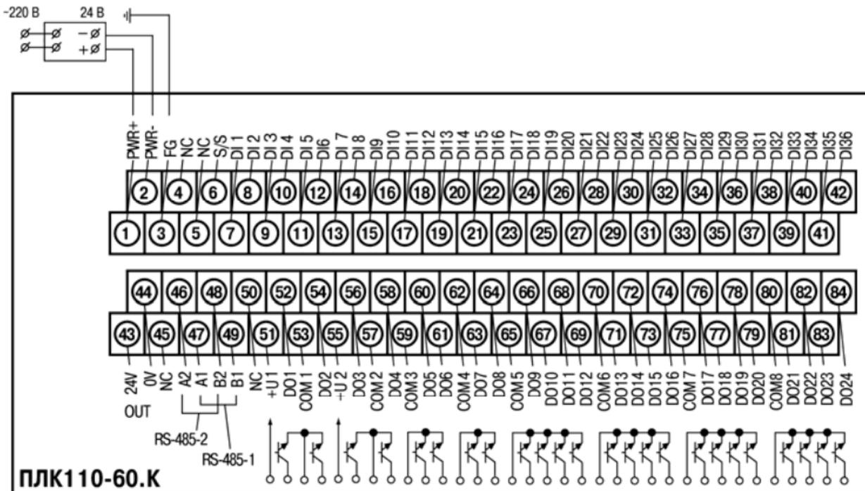
**Рисунок Б.2 – Схема расположения и назначение клемм на ПЛК110-24.60.K.
