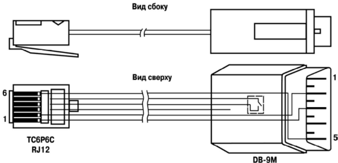
**Рисунок Г.3 – Схема кабеля КС3 «ПЛК-Модем»**
