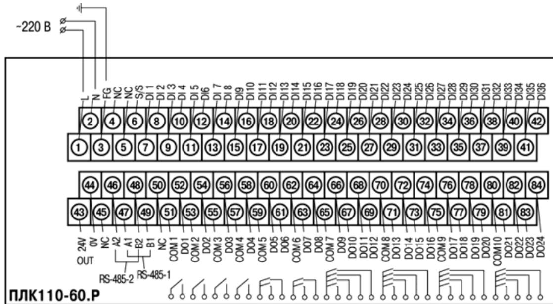
Рисунок Б.1 – Схема расположения и назначение клемм на ПЛК110-220.60.P.
