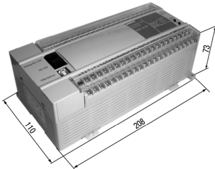
Рисунок А.1 – Габаритные размеры ПЛК110.Х.60.Х-Х
