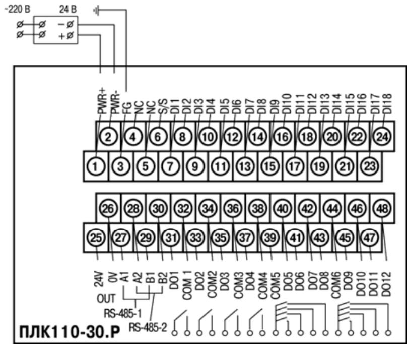
Рисунок Б.5 – Схема расположения и назначение клемм на ПЛК110-24.30.Р
