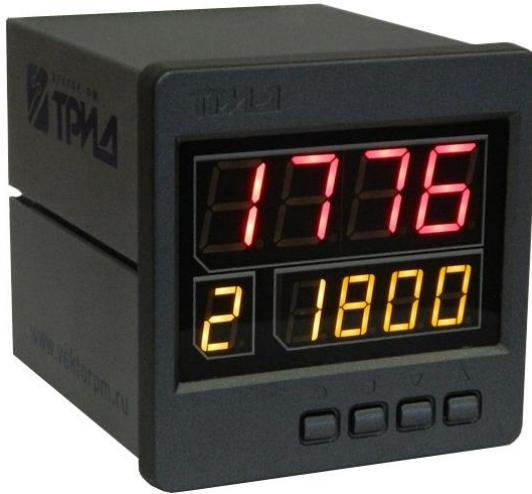
ПИД-регуляторы ТРИД РТП осуществляют регулирование технологического параметра по ПИД-закону, уменьшая мощность, по мере приближения параметра к заданному значению, что обеспечивает наиболее высокую точность поддержания параметра. Кроме того, в установившемся режиме регулирования по ПИД-закону прибор определяет величину тепловой мощности, необходимую для компенсации тепловых потерь и поддержания заданной температуры.
