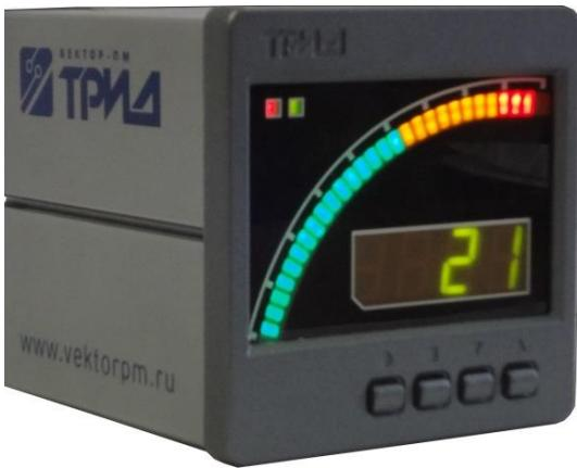
ПИД-регуляторы ТРИД РТП осуществляют регулирование технологического параметра по ПИД-закону, уменьшая мощность, по мере приближения параметра к заданному значению, что обеспечивает наиболее высокую точность поддержания параметра. Кроме того, в установившемся режиме регулирования по ПИД-закону прибор определяет величину тепловой мощности, необходимую для компенсации тепловых потерь и поддержания заданной температуры.
