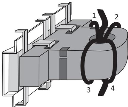
Рисунок 3 - Подключение с наматыванием нескольких витков
