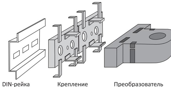
Рисунок 4 - Монтаж преобразователя на DIN-рейку
