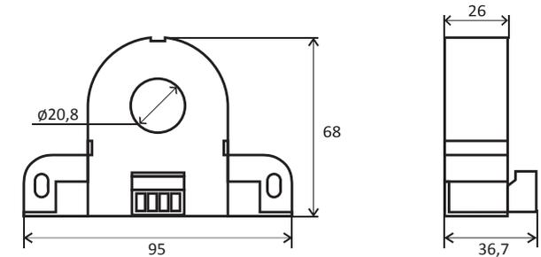
Рисунок 1 - Габаритные размеры, мм
