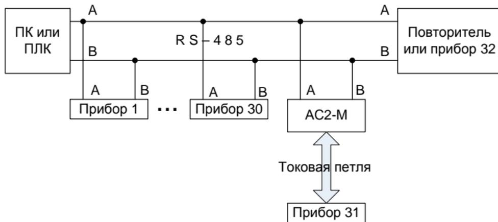
**Рис. 1.1. Типовая схема промышленной сети на базе интерфейса RS-485**
