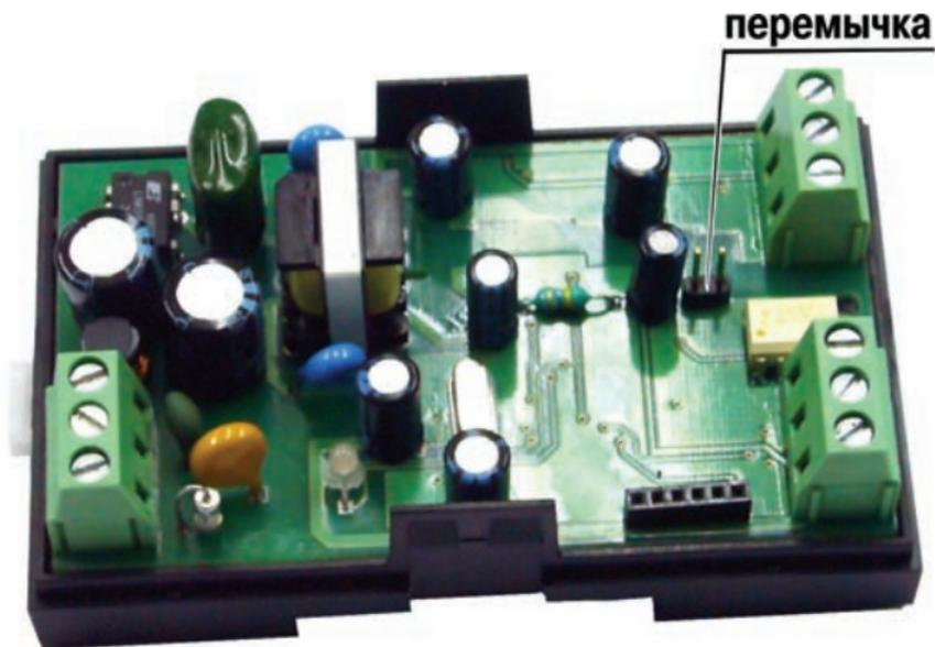
**Рис. 9.2. Установка перемычки на плате**
