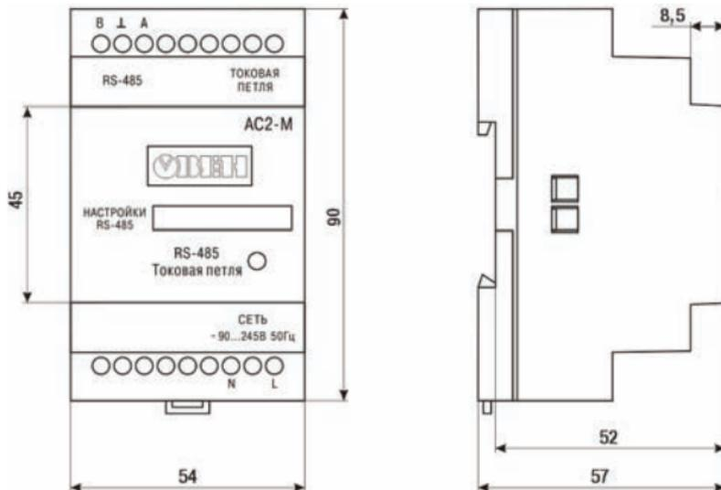
**Рис. А.1. Габаритный чертеж преобразователя AC2-M**
