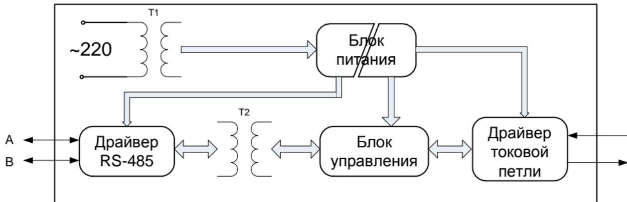
**Рис. 4.2. Функциональная схема преобразователя**
