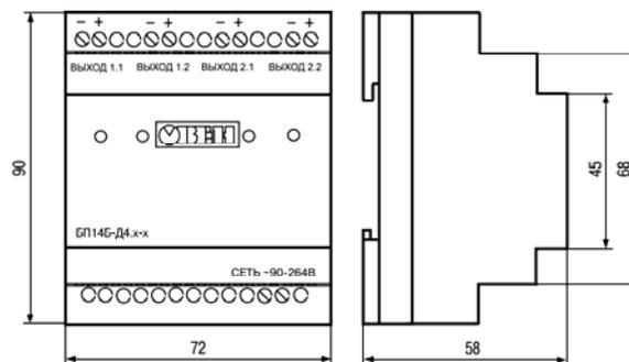
**Рисунок 1 – Габаритные размеры блока питания БП14Б-Д4.х-х**
