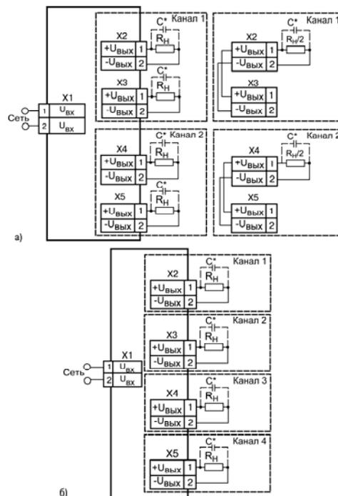
Рисунок 2 – Типовые схемы подключения блоков питания БП14Б-Д4.2-х (а) и БП14Б-Д4.4-х (б)
