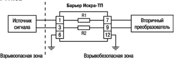
Рисунок 2 – Схема подключения барьера,  $R1=R2=110 \text{ Ом} \pm 5 \%$
