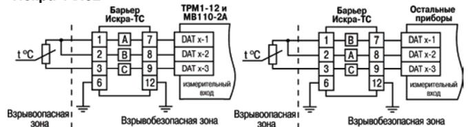
Рисунок 3 – Схема подключения барьера
