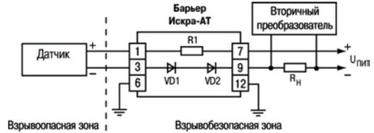
Рисунок 1 – Схема подключения барьера,  $R1=390 \text{ Ом} \pm 5 \%$ ;  $VD1, VD2$  – диоды КД208
