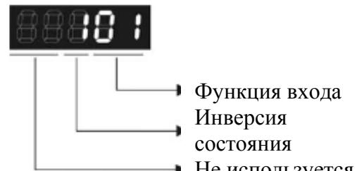
Параметр определяет назначение входа и его состояния:
