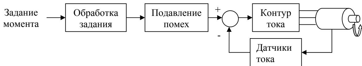
На приведенной схеме под блоком обработки команды задания принимается выбор источника задания в соответствии с разделом 6.4.1, включая максимальный момент задания аналоговым сигналом и функцию сглаживания в режиме момента. Контур тока предназначен для вычисления значения тока, необходимого для формирования заданного момента. На следующей схеме показана структура блока обработки сигнала задания в режиме момента.
