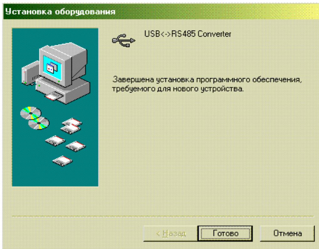
После установки драйверов в системе появляется дополнительный СОМ-порт. При работе с программой опроса «Термодат Х.ХХ» укажите его в качестве используемого порта.
