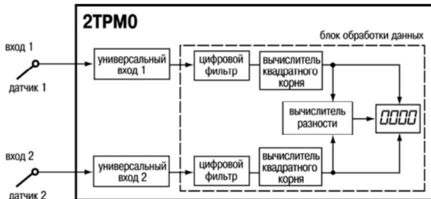
Рис. 3.1. Структурная схема прибора
