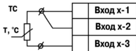
Рис. Б.1. Схема подключения термометра сопротивления
