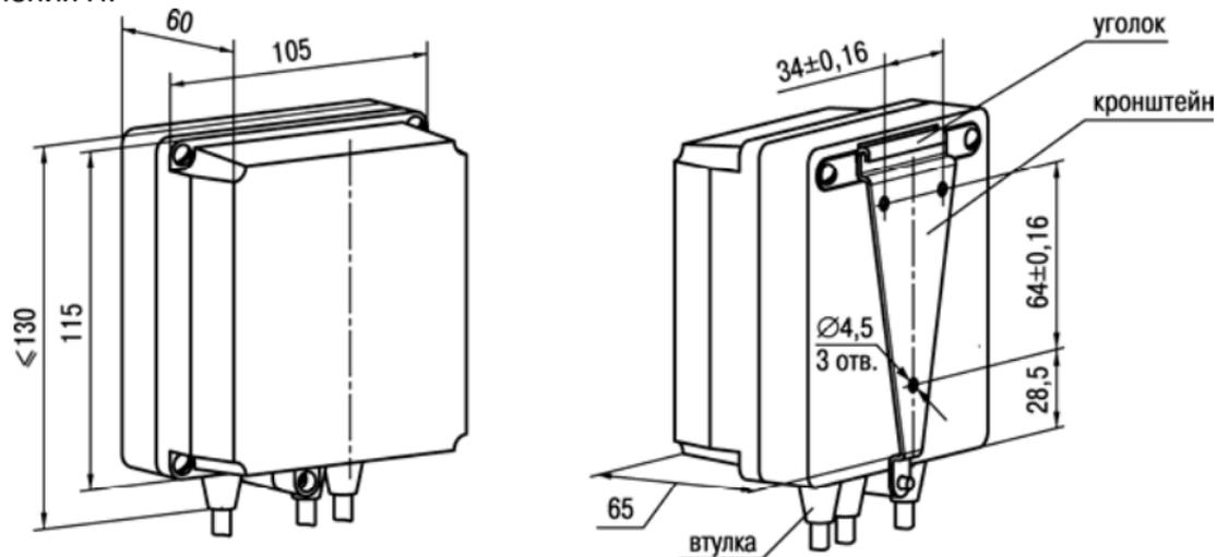
Рис. А.1. Прибор настенного крепления Н
