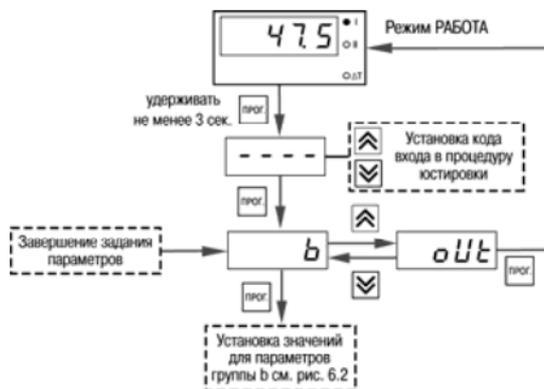
Рис. 6.1. Последовательность работы с прибором при задании параметров
