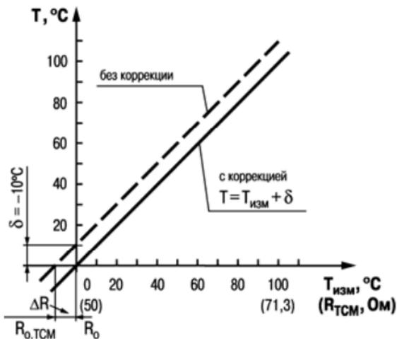
Рис. 3.3. Коррекция «сдвиг характеристики»
