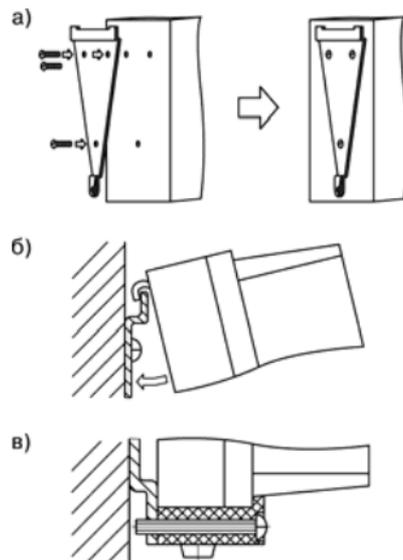
**Рис 5.1. Монтаж прибора настенного исполнения**
