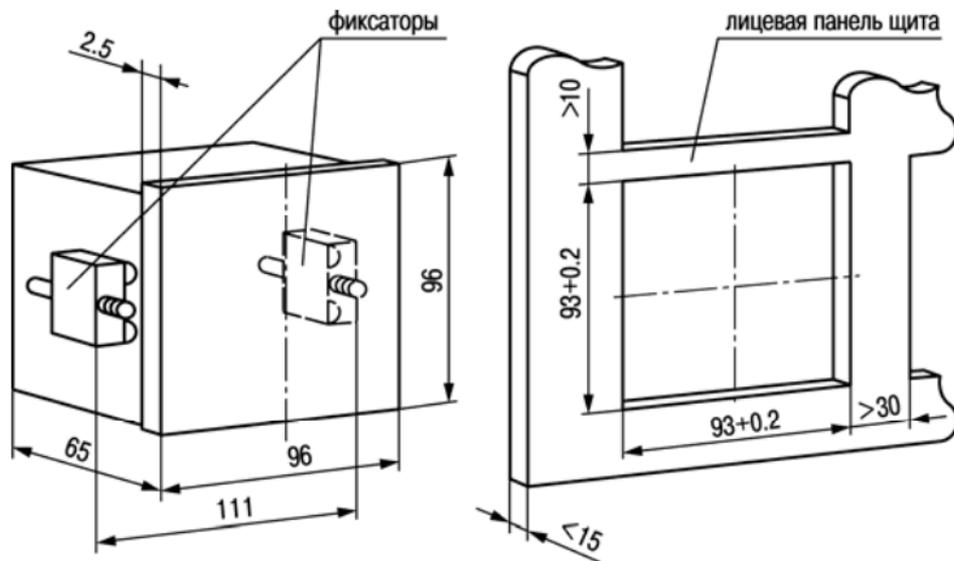
**Рис. А.2. Прибор щитового крепления Щ1**
