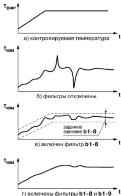
Рис. 3.2. Временные диаграммы работы Цифровых фильтров
