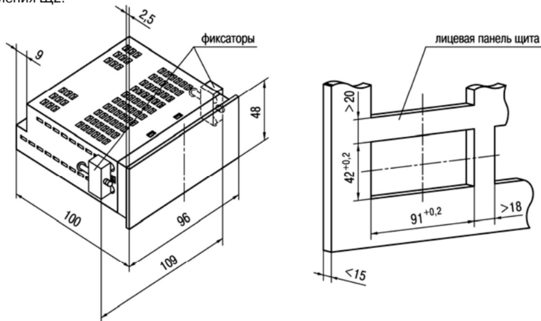
Рис. А.3. Прибор щитового крепления Щ2
