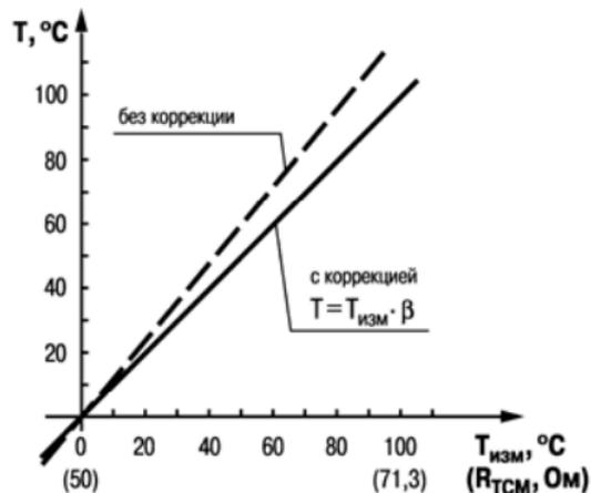
Рис. 3.4. Коррекция «наклон характеристики»
