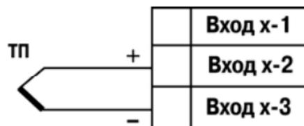
Рис. Б.2. Схема подключения термоэлектрического преобразователя
