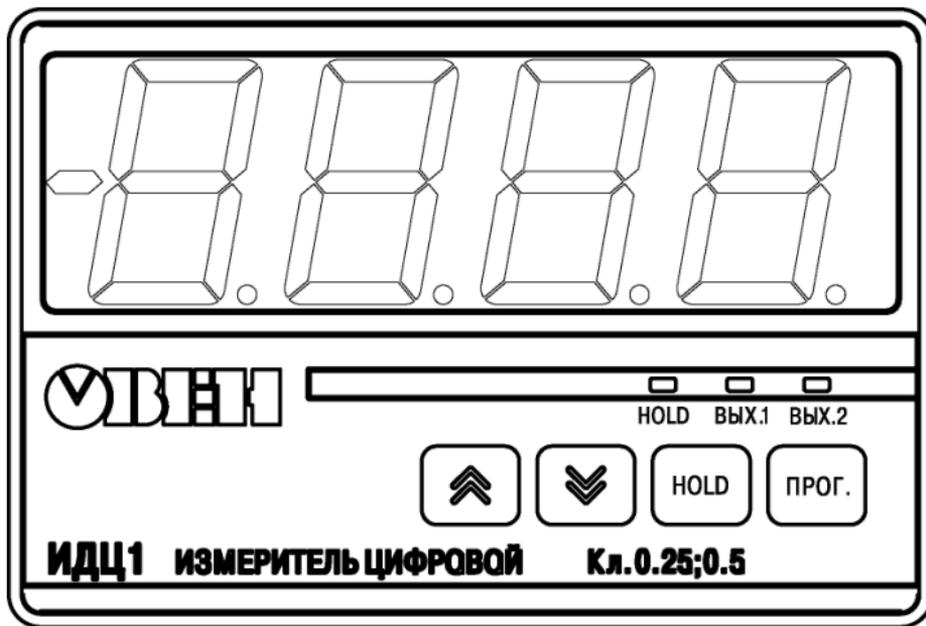
Рисунок 3.2 – Внешний вид лицевой панели прибора
