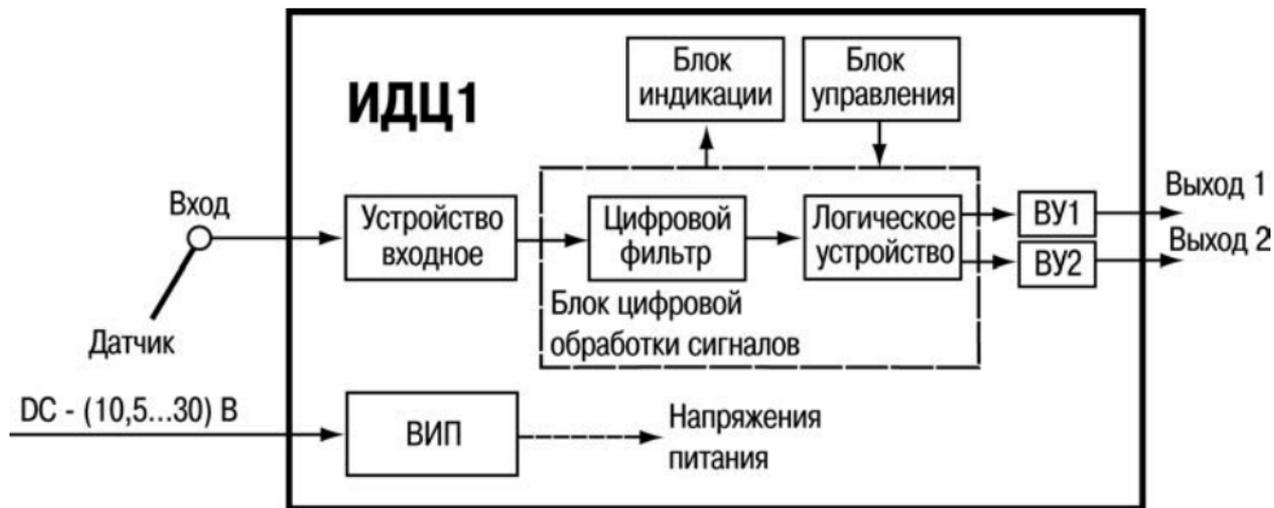
Рисунок 3.1 – Структурная схема прибора
