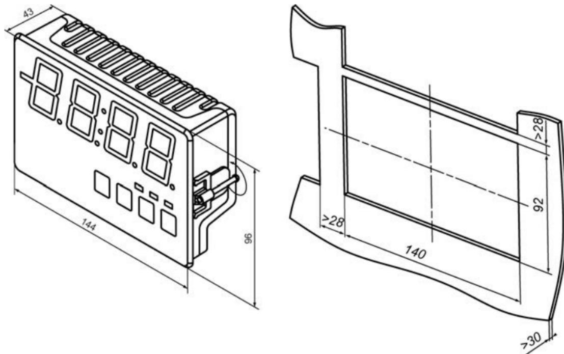
Рисунок А.1 – Прибор щитового крепления Щ8
