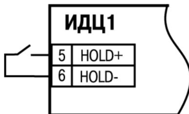
**Рисунок 6.1 – Подключение коммутирующих устройств к контактам «HOLD»**
