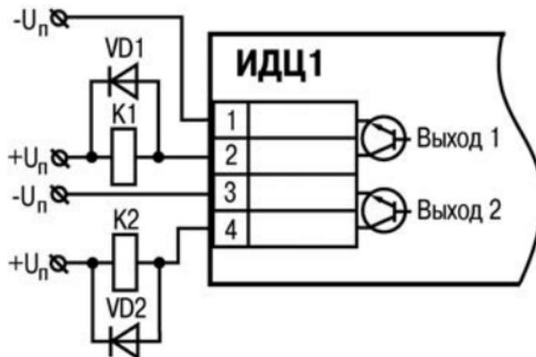
Рисунок 3.6 – Схема подключения к прибору реле
