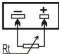
Двухпроводная схема соединений проводников
