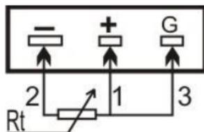
Трёхпроводная схема соединений проводников
