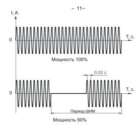
Рисунок 2 – Диаграмма зависимости тока от времени для широтно–импульсного модулирования
